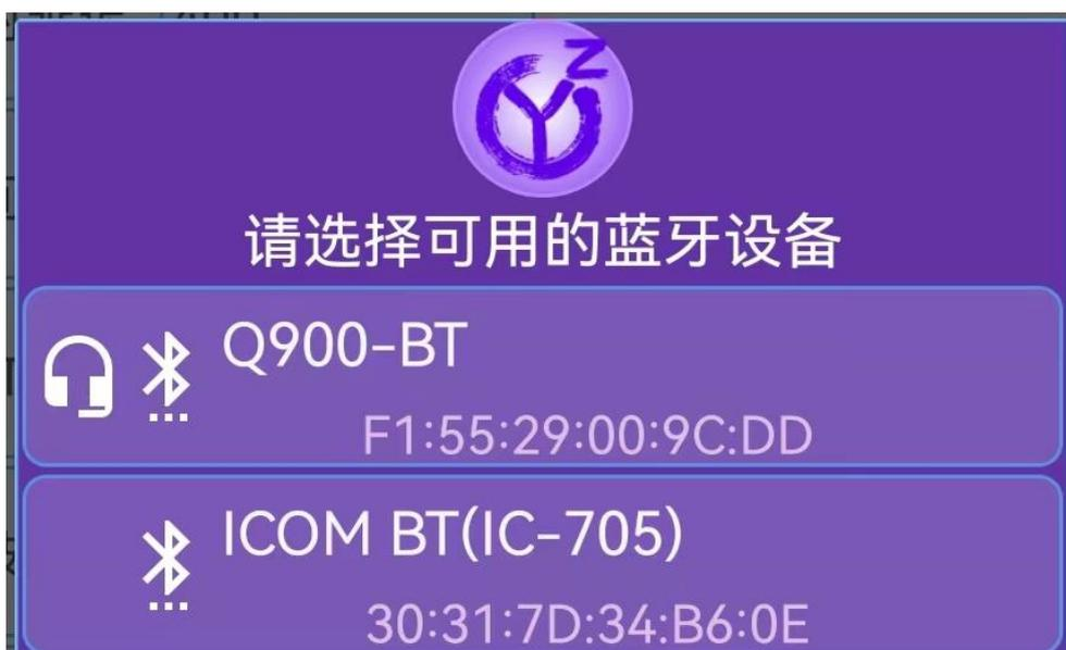
**蓝牙连接，仅仅是对电台的控制，并不包括蓝牙音频，蓝牙音频与蓝牙串口是相互独立存在的，也就是说，使用蓝牙音频，可以使用有线连接对电台控制，也可以用蓝牙串口控制。或者，使用蓝牙串口控制电台，同时用有线或 MIC 直接采集声音。如果电台支持蓝牙串口，也支持蓝牙音频，且电台的蓝牙音频支持从机模式（目前已知国赫 Q900 同时具备），FT8CN 就可以同时使用蓝牙串口和蓝牙音频进行 FT8 通联，这时手机可以完全摆脱有线的连接，真正实现无线连接。BG7IKK 尝试设计使用蓝牙模块对不具备蓝牙的老电台做控制（包括音频），目前已经成功实现，具体实现方案可以到哈啰 CQ 论坛中查找。**
