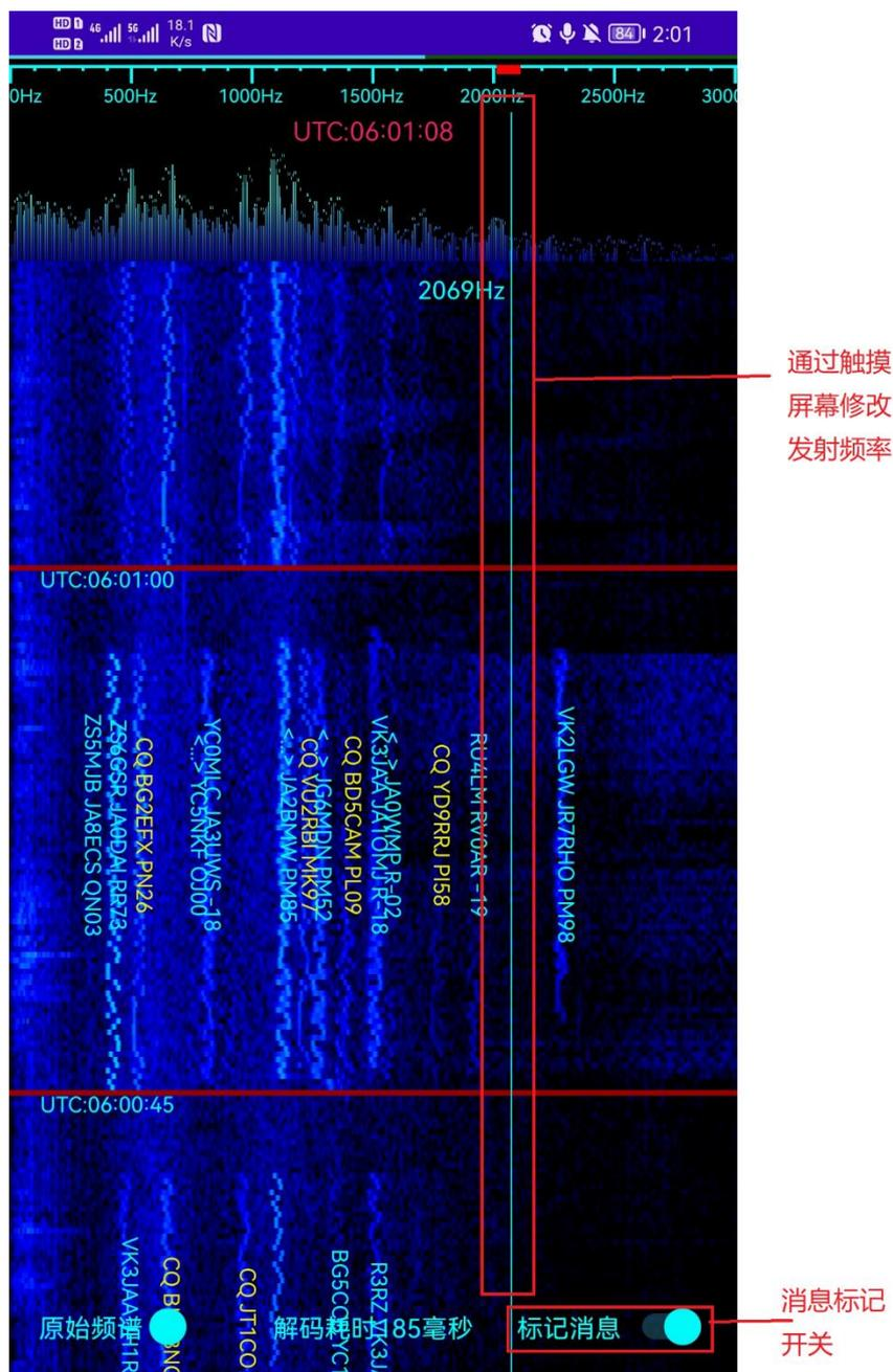
**关于频率的一点提示。**虽然正常人的耳朵能听到的声音频率最大范围是 20Hz~20000Hz，但是，由于 FT8 模式 使用单边带发射，调制最大带宽是 3KHz，现在有些业余电台设备使用的是无源窄带滤波器，带内不平坦，当音频设置小于 400Hz，大于 2600Hz 时发射功率急剧下降。所以选择发射的声音频率，建议在 300Hz~2800Hz 之间。
